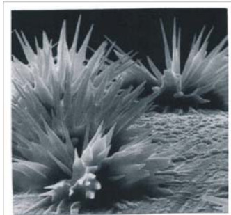
Bild 10: Kristallbildung in einer Phosphatschutzschicht
