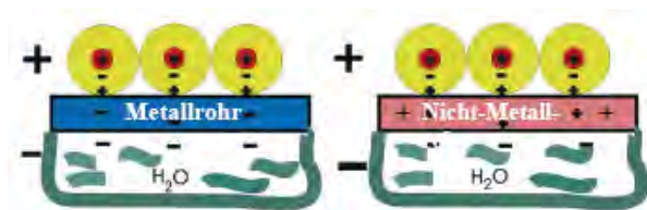
Bild 6: Übertragung eines elektrischen Feldes ins Wasser durch Influenz
